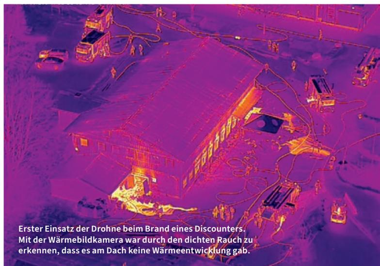
Erster Einsatz der Drohne beim Brand eines Discounters. Mit der Wärmebildkamera war durch den dichten Rauch zu erkennen, dass es am Dach keine Wärmeentwicklung gab.
