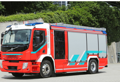
In Anlehnung an ein HLF 20, AT electric – Advanced Technology - auf Volvo-Fahrgestell FE elektrisch 4x2, Leistung 225 kW/400 kW Spitze. Wasserbehälter 2000 l, Pumpe N20.
