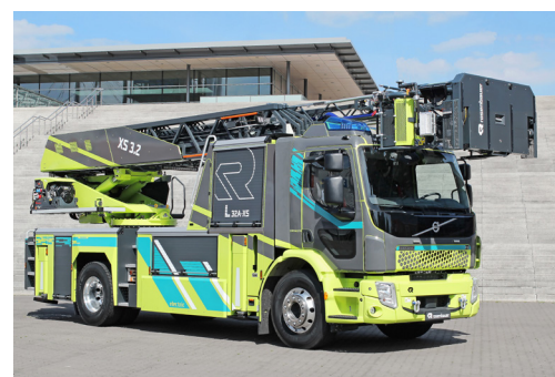
Drehleiter L 32A-XS electric für die Berufsfeuerwehr Zürich.
