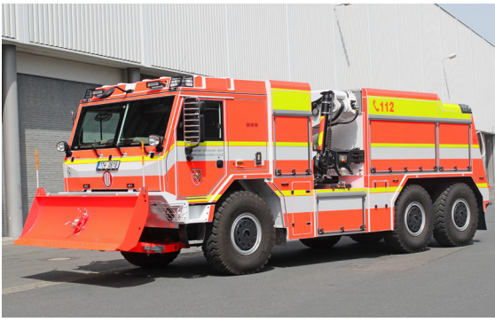
Für den technischen Einsatz: Sonderfahrzeug „Rescue Vehicle 6x6“ mit Hiab Kraneinrichtung 222 ATF-2 auf Tatra-Fahrgestell mit 325 kW. Heckseitig zwei Seilwinden.
