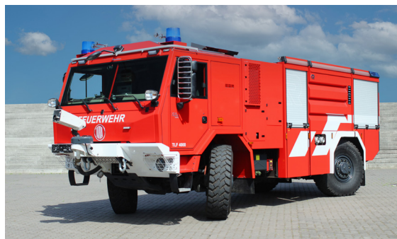
TLF 4200/150, MT Modular Technology; Tatra Force T815 4x4, 291 kW. 4200 l Wasser, Pumpe N25. Frontseitig Monitor RM 15C. Aufbau Rosenbauer. Bemerkenswert die eingeschlagene Hinterräder.
