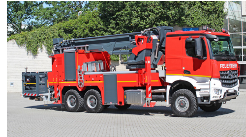
Teleskopmast (TM B24-PRV) bzw. Pilotenrettungsfahrzeug der Bundeswehr auf MB Arocs 3346 6x4, zG. 26.000 kg. Übergroße Rettungsplattform, max. Belastung 750 kg. Aufbau Rosenbauer.
