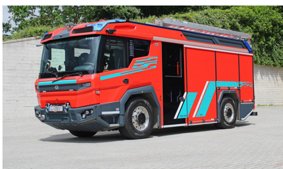
Mit Elektroantrieb in die Zukunft: RT – Revolutionary Technology der Firma Rosenbauer, hier als Vorführer (RT 4x4 Advanced); Pumpe N35, 2000 l Wasser + 120 l Schaummittel.
