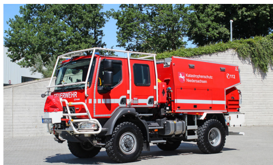
TLF-Waldbrand (CCFM 3000) auf Renault D14 R4x4, Ausführung Katastrophenschutz Niedersachsen. 3000 l Wasser, 80 l Schaummittel, PFN 10-2000, Frontmonitor und Winde 50 kN. Aufbau Iturri.
