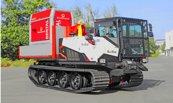
Kässbohrer Kettenfahrzeug PowerBully 9C mit 235 PS für unwegsames Gelände. Wattiefe 1,10 m. u. Steigfähigkeit bis zu 60 Prozent. Abrollbehälter mit Equipment zur Brandbekämpfung.
