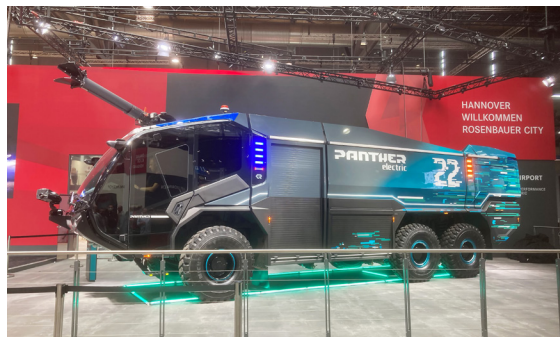
Messe-Highlight: Die Präsentation des ersten Flughafenlöschfahrzeugs PANTHER 6x6 electric mit elektrischem Antriebsstrang.
