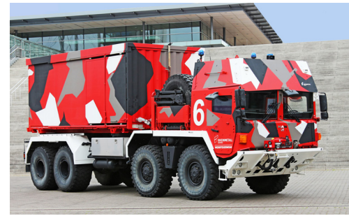
Für den Waldbrandeinsatz GTLF auf 4-Achs-Fahrgestell MAN SX 45 8x8 (440 PS), WF Rheinmetall. Im AB TS Ultra Power 4 sowie 10.000 l Wasser. Frontmonitor 2000 l/min. Gewicht 58 Tonnen.
