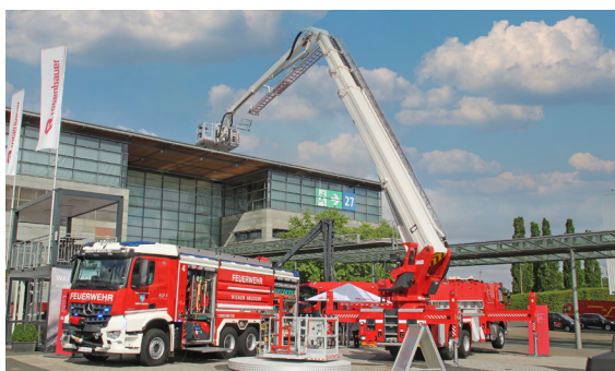
Weltneuheit: Die Rosenbauer-Drehleiter mit abneigbarem Korbarm L 32A-XS electric auf voll-elektrischem Serienfahrgestell mit zwei Elektromotoren, gesamt 225 kW.
