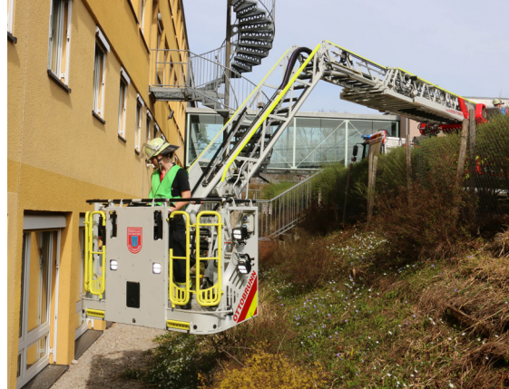
Konzentriert steuert die Kameradin den Korb an das Fenster im Souterrain der Grundschule 2 heran. Hier wird der Vorteil des abwinkelbaren ersten Leiterteils deutlich.
