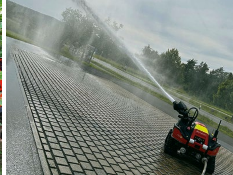
Der Lösch- roboter aus Hollfeld wurde den Übungsteil- nehmern zum Schluss noch in Aktion gezeigt.
