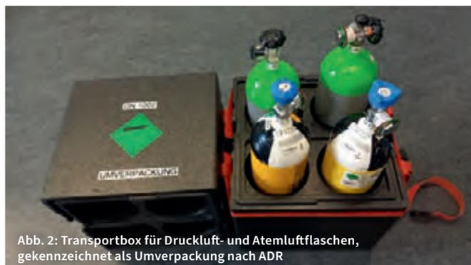
Abb. 2: Transportbox für Druckluft- und Atemluftflaschen, gekennzeichnet als Umverpackung nach ADR
