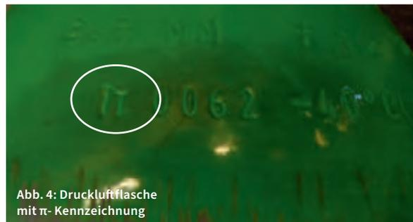
Abb. 4: Druckluftflasche mit π-Kennzeichnung
