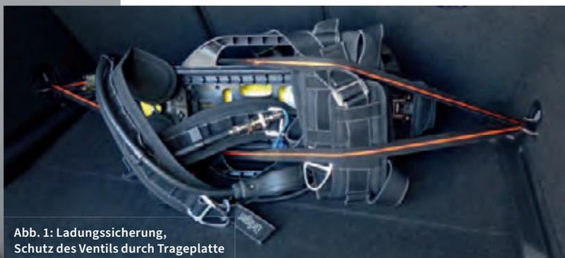
Abb. 1: Ladungssicherung, Schutz des Ventils durch Trageplatte
