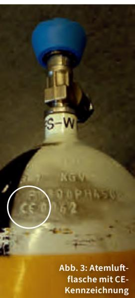
Abb. 3: Atemluftflasche mit CE-Kennzeichnung
