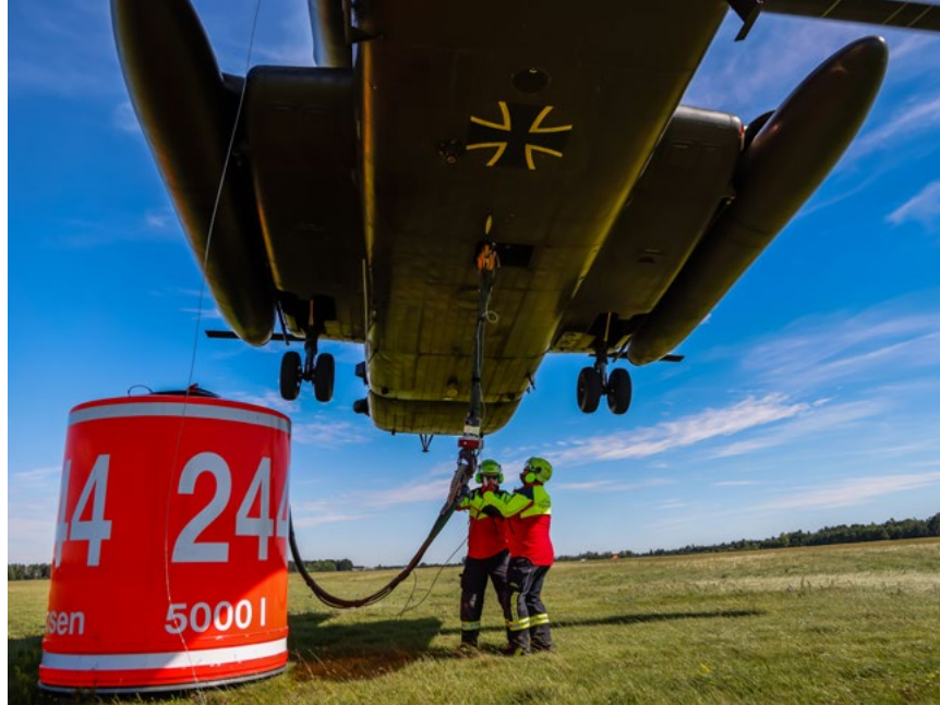
Flughelfer bringen Außenlast-Löschbehälter an
