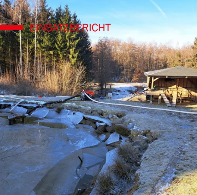
Aufbau der Wasserförderung über lange Schlauchstrecken von einem Löschweiherr
